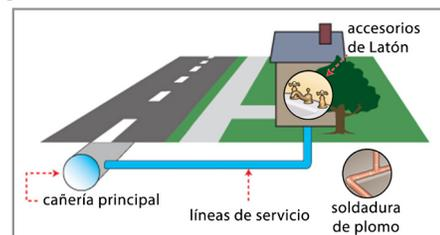
**Soldadura de Plomo** – la soldadura comúnmente contiene plomo y se utiliza para conectar las tuberías de cobre.
